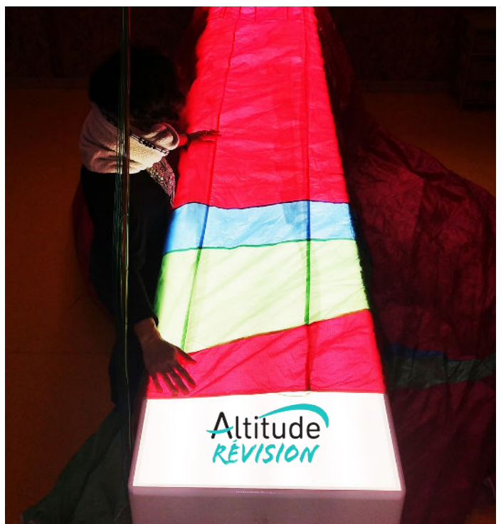
Contrôle visuel de l'aile sur table éclairante Crédit photo : Atelier de contrôle Altitude-révision
